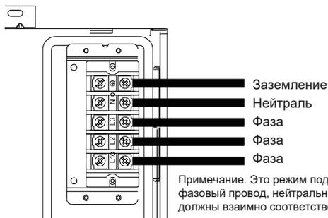
Примечание. Это режим подключения для трехфазной сети, и фазовый провод, нейтральный провод и провод заземления должны взаимно соответствовать друг другу.
