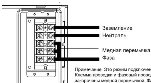
Примечание. Это режим подключения для однофазной сети. Клемма проводки и фазовый провод должны быть закорочены медной перемычкой. Фазовый провод, нейтральный провод и провод заземления должны взаимно соответствовать друг другу
