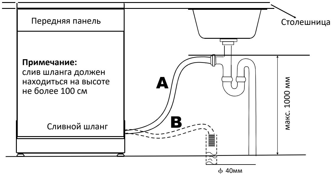
Подключение к системе водоотведения должно располагаться на высоте до 100 см (максимальная) от дна моечной камеры посудомоечной машины. Если слив расположен на высоте более 100 см от пола, вода не сможет напрямую сливаться в систему водоотведения. В таком случае необходимо предусмотреть выпуск сливного шланга в подходящую емкость (раковину и т.п.), расположенную в допустимых пределах по высоте.
