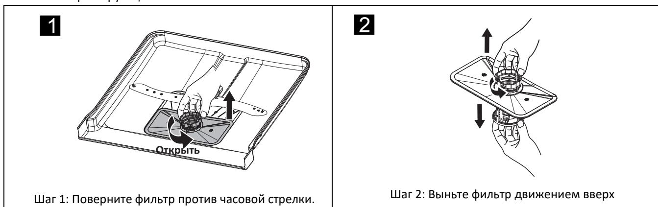
Чтобы извлечь фильтр, произведите по порядку указанные действия (с 1 по 2); чтобы поставить фильтр обратно, произведите действия в обратном порядке (со 2 по 1).
