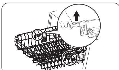
Для опускания корзины поднимите обе регулировочные ручки по ее сторонам и опустите корзину в нижнее положение.
