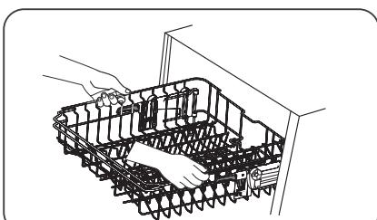
Для подъема корзины возьмите ее за середину и потяните вверх до фиксации в верхнем положении. Не используйте для этого регулировочные ручки.
