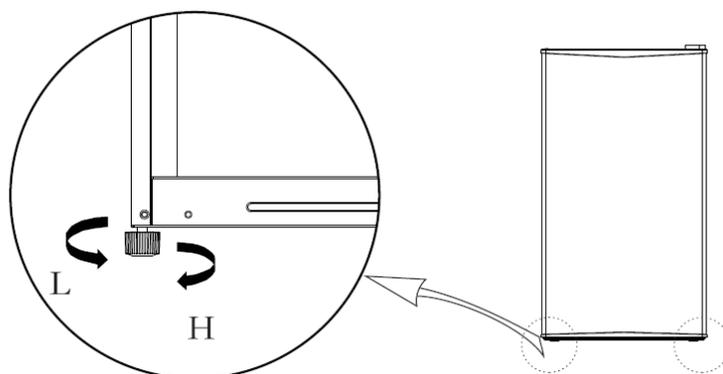
Если холодильник установлен не по уровню, дверь и магнитные уплотнители будут закрываться неплотно.
