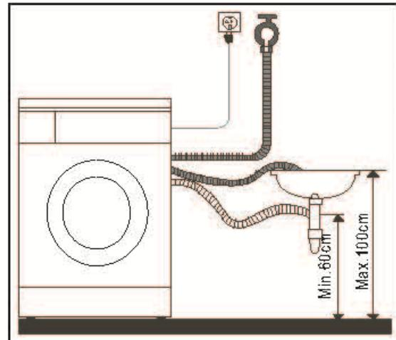
Для слива воды непосредственно в канализацию сливной шланг машины устанавливается выше колена стока (сифона) в канализационную трубу с внутренним диаметром не менее 40 мм во избежание обратного засасывания сточной воды в машину. Сливной шланг может подключаться непосредственно к сифону с патрубком.
