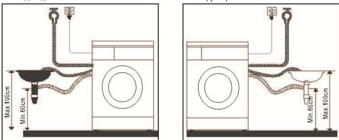
Для слива воды непосредственно в канализацию сливной шланг машины устанавливается выше колена стока (сифона) в канализационную трубу с внутренним диаметром не менее 40 мм во избежание обратного засасывания сточной воды в машину. Сливной шланг может подключаться непосредственно к сифону с патрубком.
