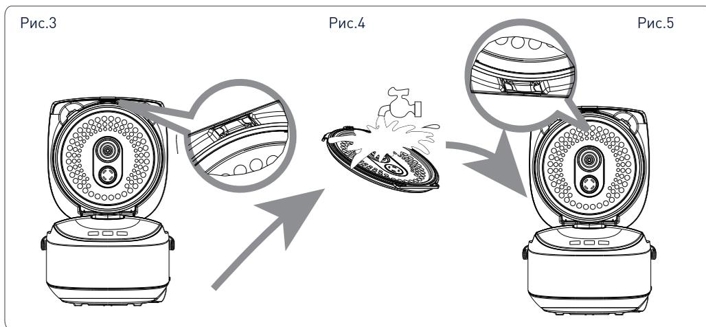
6. Отделите от крышки съемный паровой клапан, для этого потяните его за выступ вверх. Нажмите на фиксатор PUSH в нижней части клапана и разъедините его. Тщательно промойте детали под проточной водой. После очистки и сушки соберите клапан и установите его на крышку, зафиксируйте, слегка нажав на него рукой.
