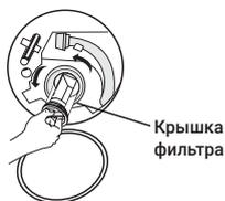
4. Откройте фильтр, повернув его против часовой стрелки.
