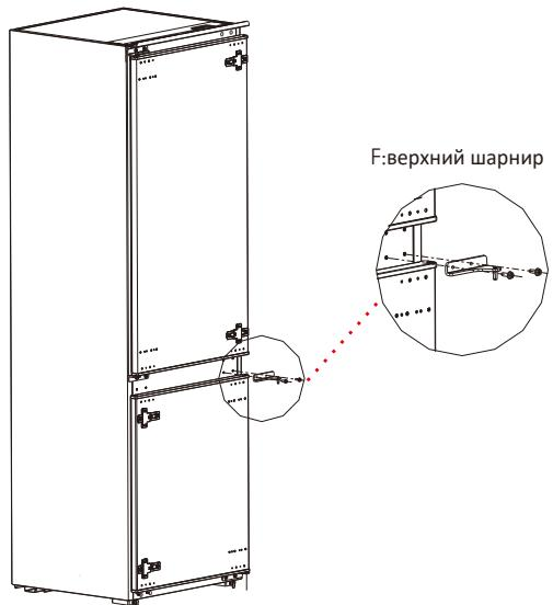
6) Отвинтите верхний шарнир двери морозильной камеры и снимите дверь.
