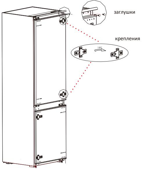
5) Перевинтите крепления для дверной панели на противоположную сторону двери. Установите заглушки для отверстий.
