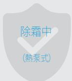
當室外溫度低、濕度高時，ODU 的熱交換器可能會結霜，進而降低空調的暖氣能力。如果發生這種情況，空調會停止加熱，進入自動除霜模式，並在除霜完成後返回暖氣模式。除霜期間，室外風扇停止運轉，而室內風扇開始運轉，並使用防冷風保護功能。除霜作業時間視室外溫度與結霜程度而定。一般需要 2 到 10 分鐘。在除霜過程中，ODU 可能會因為快速除霜而冒出蒸氣，這屬於正常現象。
