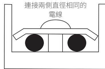
**D** 請勿將線徑相同的電纜壓在端子的同一端。請勿將線徑不同的兩條電纜用於相同端子台，否則很容易因受力不均而鬆脫，並造成意外，如下圖所示。
