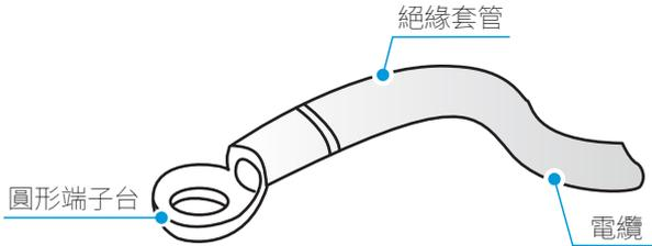
**C** 若因現場限制無法壓接絕緣圓形端子台，可將相同直徑的電纜連接至 IDU 的電源端子台兩側，如下圖所示。
