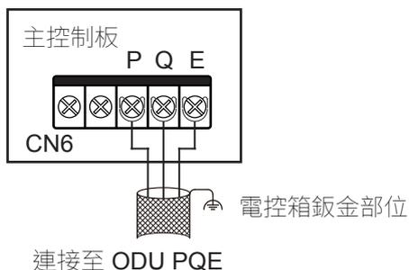
系統：IDU 與 ODU 的 P/Q/E 通訊電纜最大總長度可達 1200m，並可以串連方式連接，如下圖所示：
