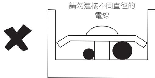
**E** 連接的電纜應使用線夾鎖緊，以防止鬆脫，如右圖所示。
