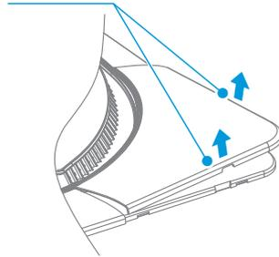
3 鬆開面板四個邊角的緊固螺絲，將面板四個邊角的掛鉤從 IDU 取下。
