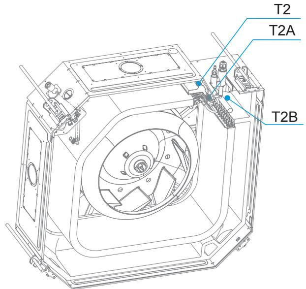
8 拆下 IDU 與 ODU 的連接管，並旋開管路密封板的兩顆螺絲，以取下密封板。
