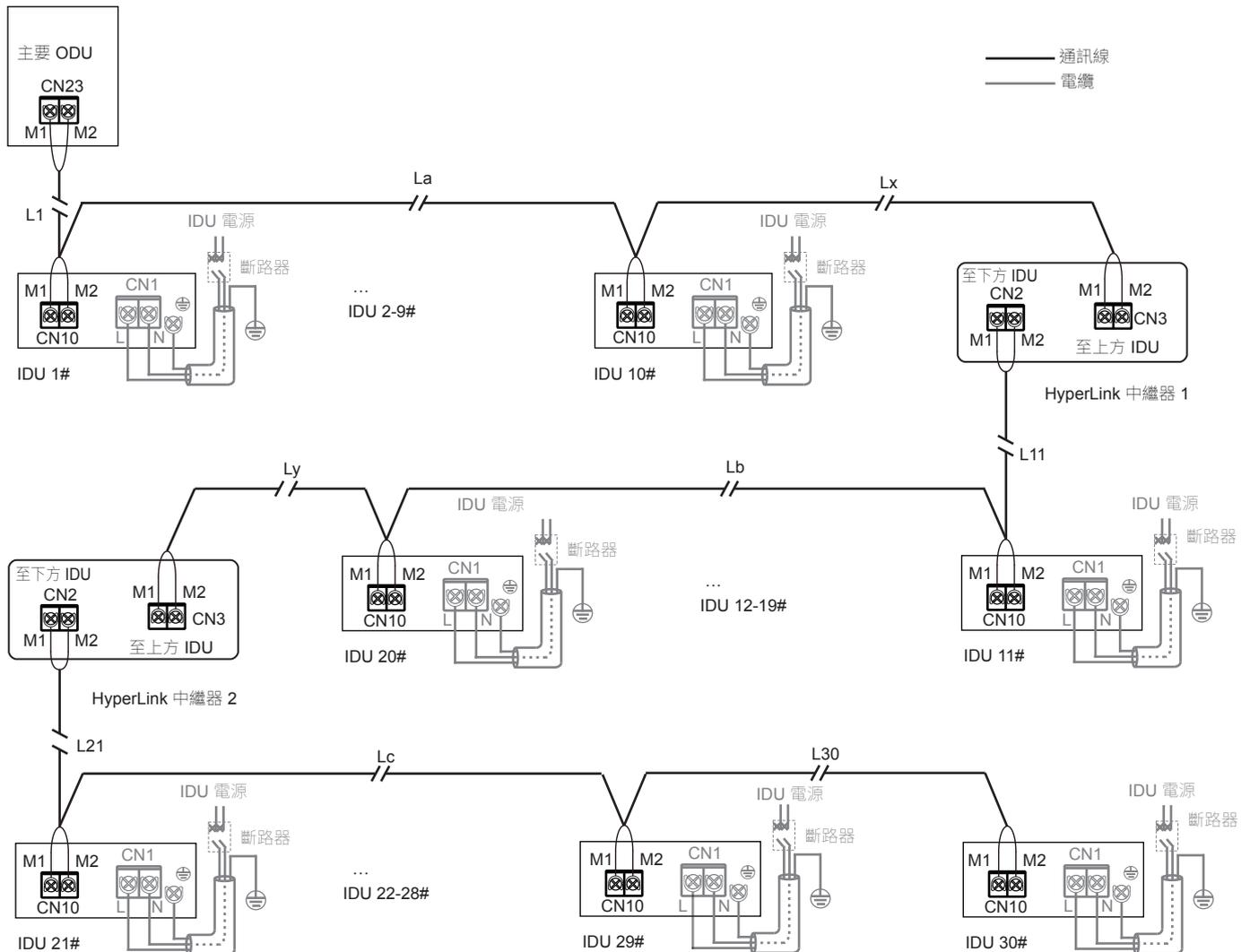
$$L1+La+Lx \leq 200\text{m} \quad L11+Lb+Ly \leq 200\text{m} \quad L21+Lc+L30 \leq 200\text{m}$$
