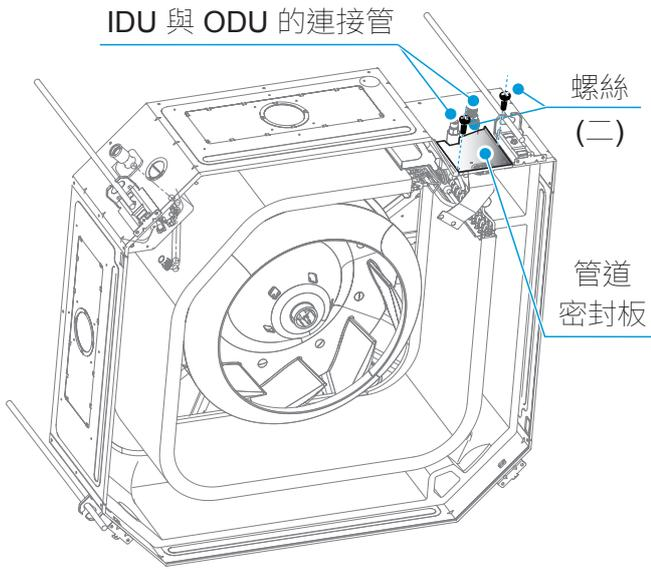
9 卸下三顆固定螺絲後，取下蒸發器固定板。然後取下蒸發器。
