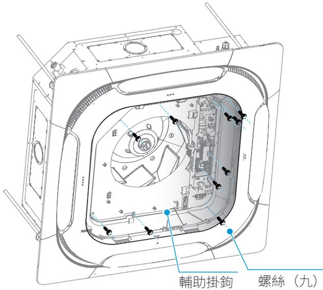
3 取下風扇中央的螺帽與風扇扣後，更換風扇。取下含平墊圈的螺帽與圖中所示位置的風扇扣，並取下離心風扇。
