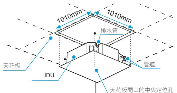
依安裝紙板四角的吊裝螺栓孔，確定吊裝螺栓的位置。
