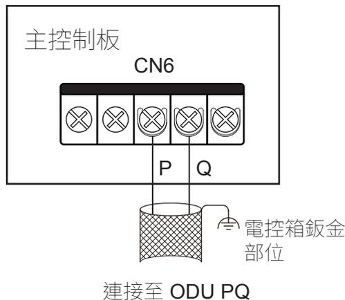
系統：IDU 與 ODU 的 P/Q 通訊電纜最大總長度可達 1200m，並可以串連方式連接，如下圖所示：
