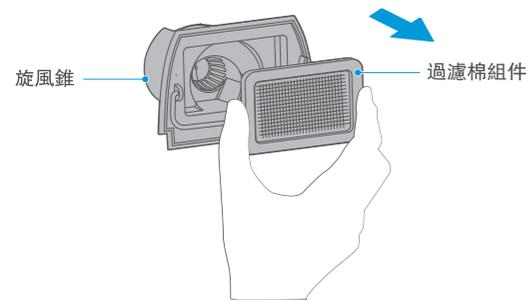
4.清潔塵杯；拍打過濾棉（切記不可反向拍打）。
