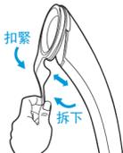
將褲縫夾上端扣合在燙頭上邊緣，下端凸台扣合於燙頭下方。
