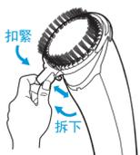
將毛刷上端扣合於燙頭上邊緣，燙頭對正毛刷下邊緣凸台後扣緊。
