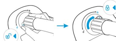
1. 將蒸汽管固定件的凸台標誌對準“0”標誌，並插到底。
